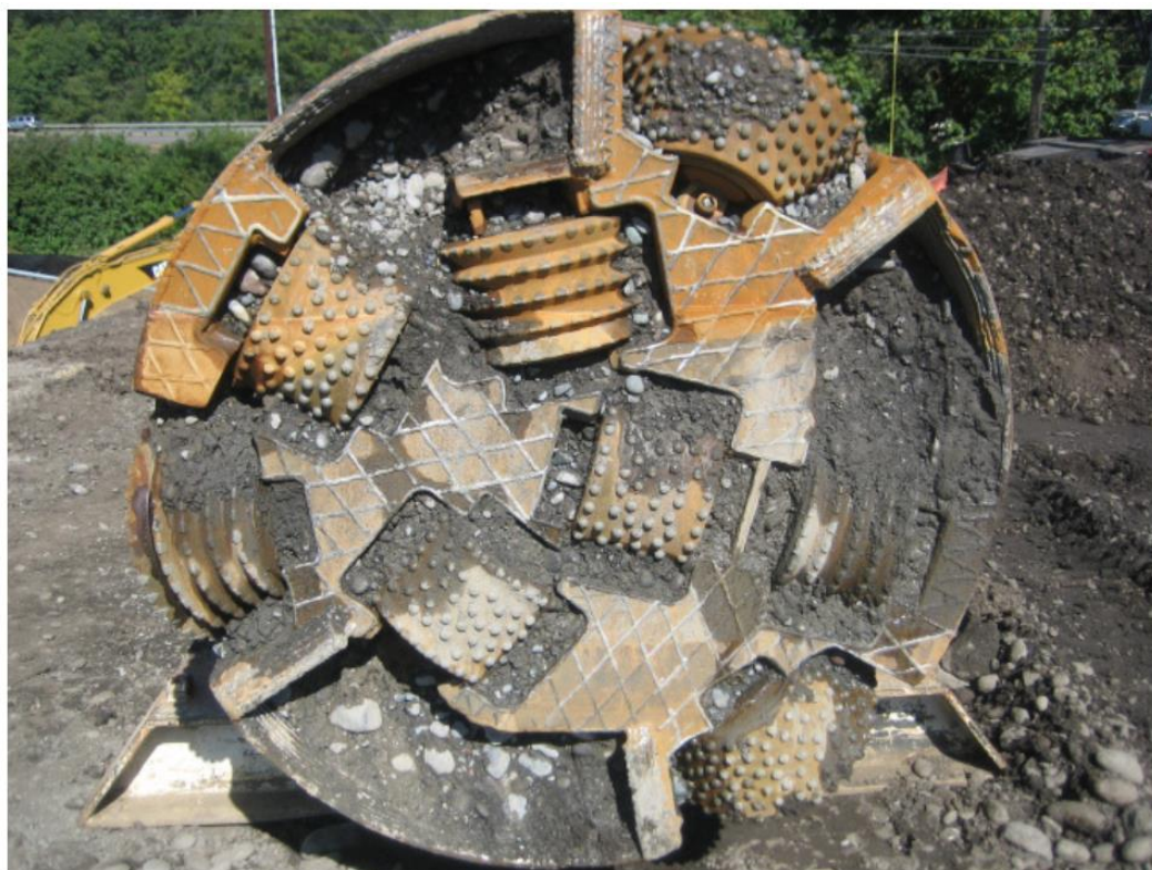
Figura 7-G : MTBM con testa fresante condizionata da" misto pesante"
