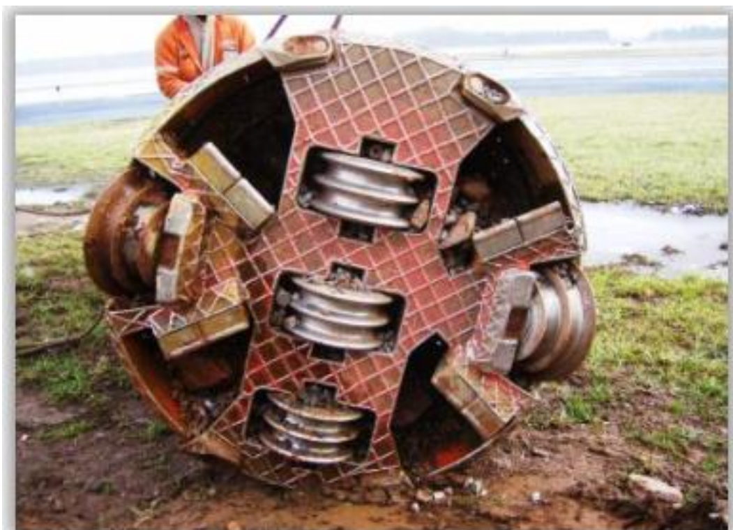
Figura 7-H : MTBM con testa fresante condizionata da" misto pesante"
