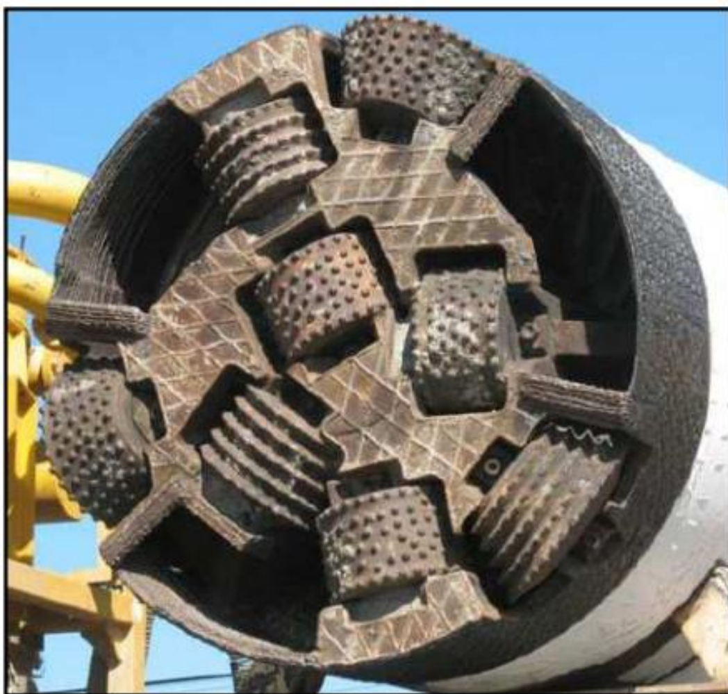
Figura 7-F : MTBM DN600 con testa fresante condizionata da "misto pesante"
