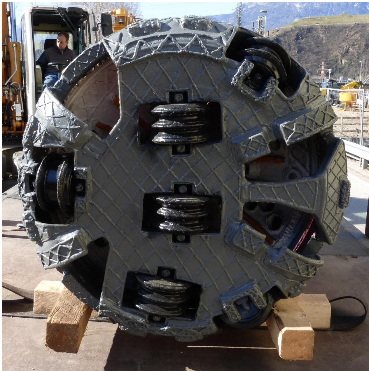
Figura 7-L : MTBM con testa fresante condizionata da "misto pesante" utilizzata nel cantiere di Bolzano
