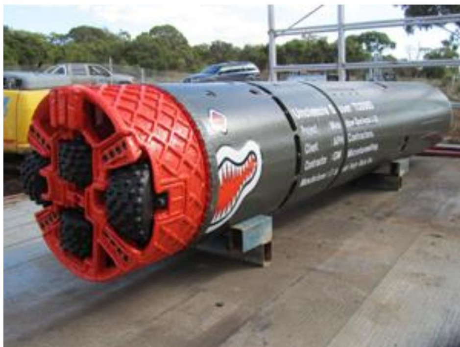
Figura 7-J : MTBM con testa fresante condizionata da "misto pesante"
