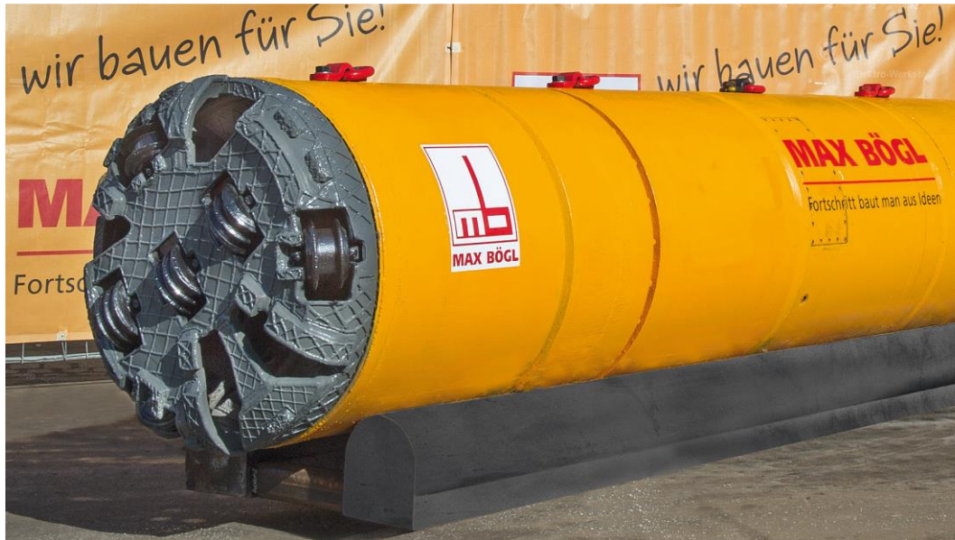
Figura 7-K : MTBM con testa fresante condizionata da "misto pesante" utilizzata nel cantiere di Bolzano
