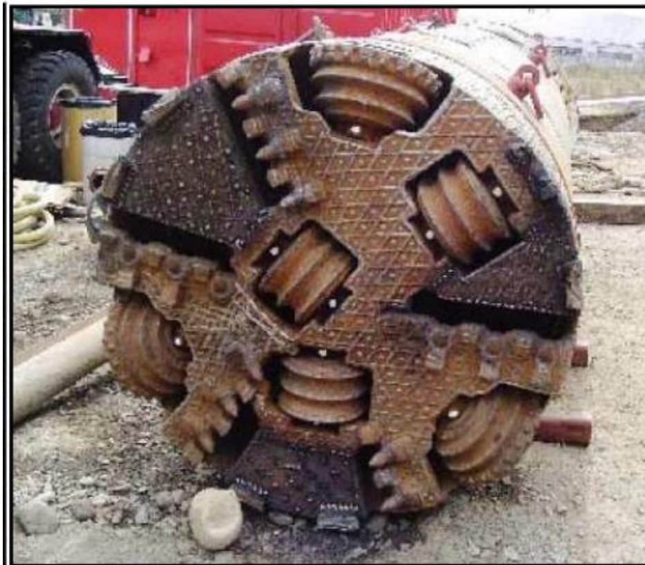
Figura 7-I : MTBM con testa fresante condizionata da "misto pesante"
